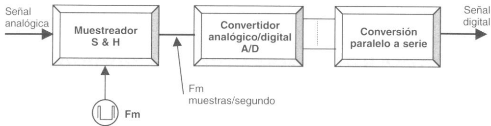
Fig. 6.2.- Proceso básico de digitalización de una señal analógica
